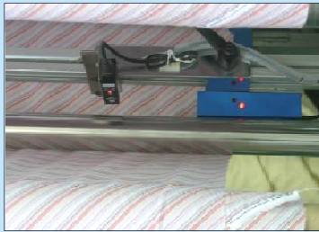
對邊感測器/缺料感測器 Edge sensor/no cloth detector
