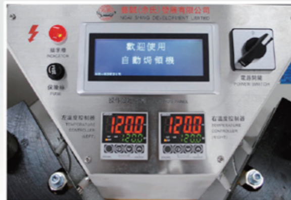
PLC 控制面板 PLC Control Panel
