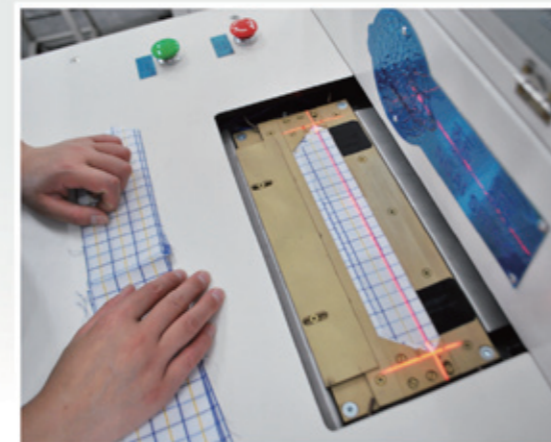
NS-5503 鐳射燈精確定位 Laser light for positioning
