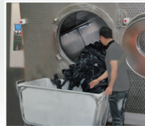
可傾斜卸料系統（跟機件） Tiltable system for garment unloading (standard)
