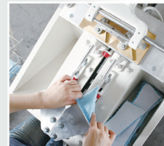
NS-44反領操作 Collar turning
